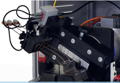
**17 Prüfung der Biegefestigkeit von Drähten**
