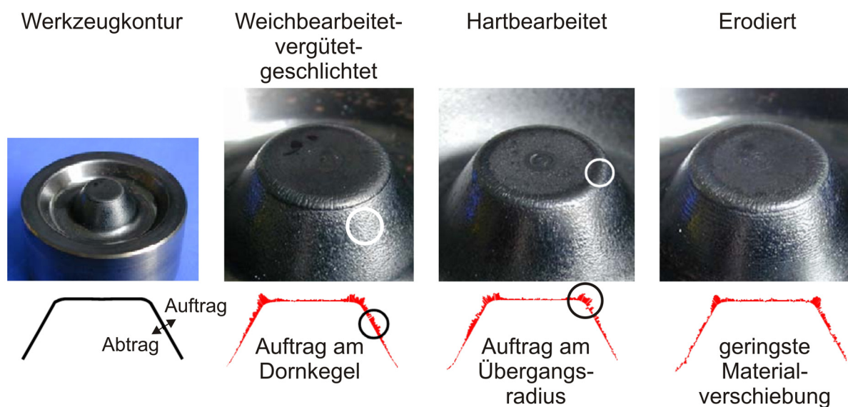
Abbildung 3: Werkzeugkontur und Verschleißmessung nach 500 Umformzyklen
