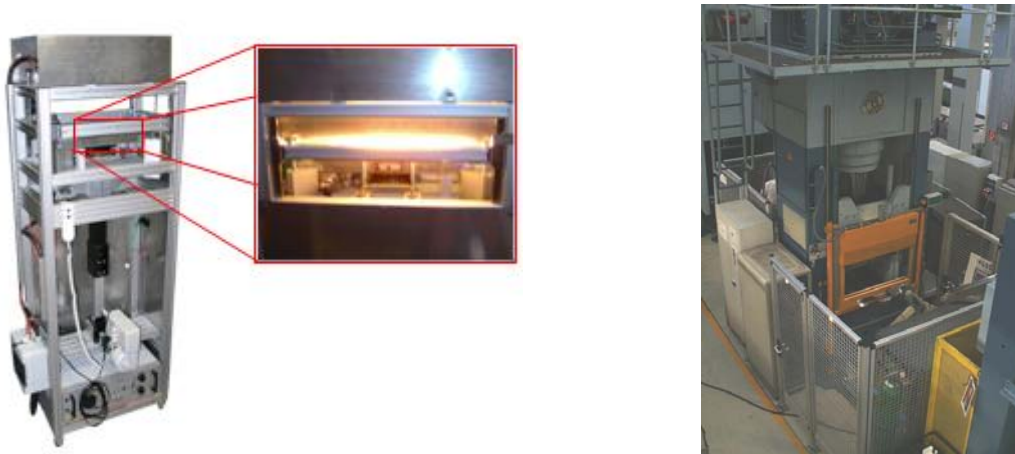
Bild 3: Infraroterwärmungsanlage und Hochgeschwindigkeitspresse
