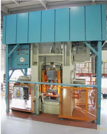
Abbildung 3: Automatische Exzenterpresse; SpeedForge PK1000S
