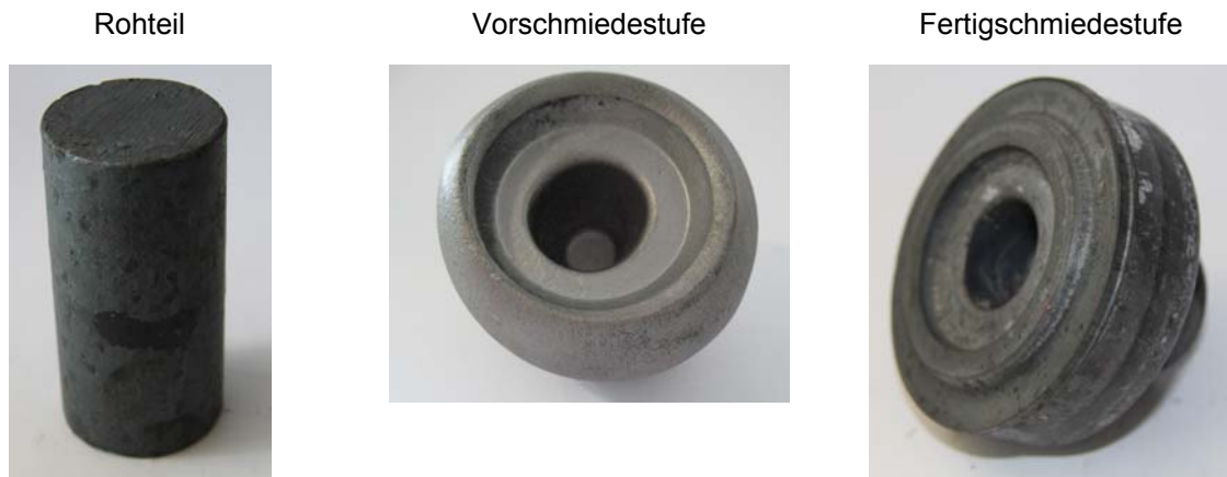
Abbildung 8: Stadienfolge Rohteil-Vorstufe-Fertigstufe (IFUM-Laborbauteil)
