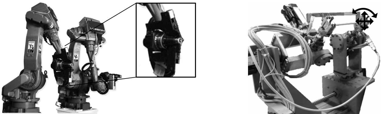
Bild 1.23 - Roboter-Biegezentrum der Firma UNISON [90] (links) Endgesteuertes Biegen mit Manipulatoren nach THALMAIR [92] (rechts)
