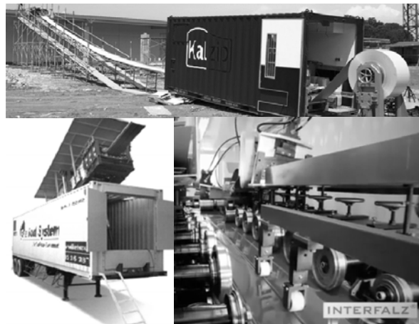
Bild 1.29 - Mobile Rollformanlagen für Dach- und Fassadenpanelen, Firma Kalzip [106] (oben), Firma Ilkwang Metal Forming Ltd. [107] (unten links) und Firma Interfalz [105] (unten rechts)
