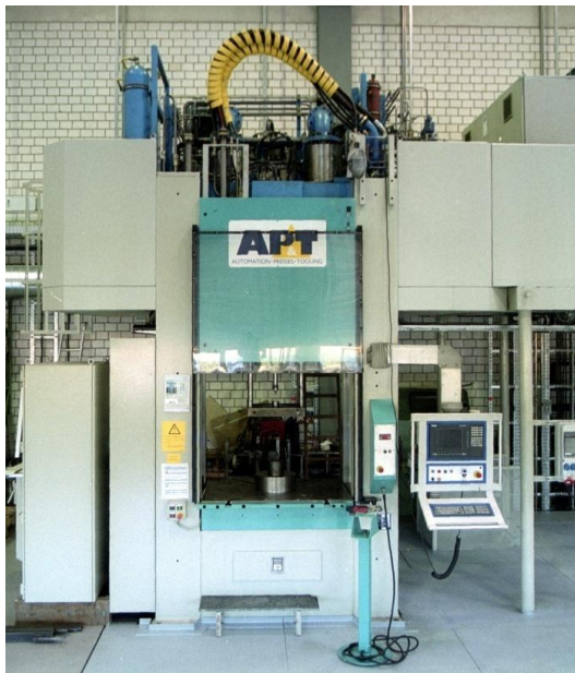
Abbildung 4: Maschinen zur Versuchsdurchführung (links: Hydraulische Presse AP&T, rechts: servohydraulischer Umformsimulator)
