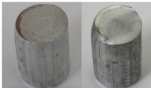
a) Scherspalt: 0,5mm b) Scherspalt: 2,5mm Schergeschwindigkeit: 430 mm/s
