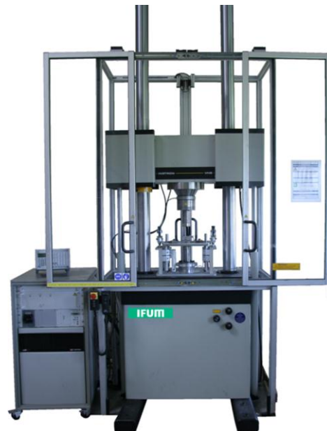
Abbildung 4: Maschinen zur Versuchsdurchführung (links: Hydraulische Presse AP&T, rechts: servohydraulischer Umformsimulator)
