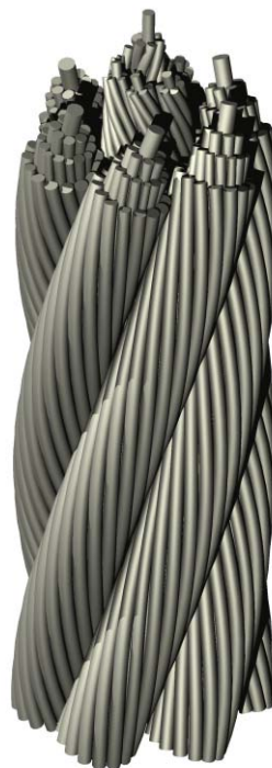
Abb. 3: Darstellung des Litzenseils 6x36 WS IWRC mit Autodesk® Inventor
