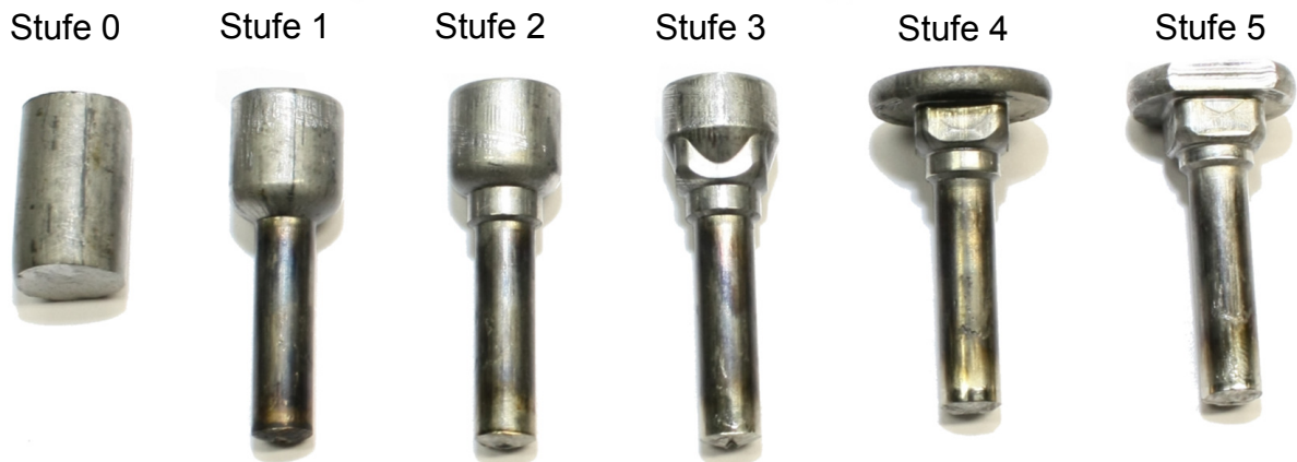
Abbildung 12: Bauteile aus 1.3815 der Stadienfolge des industriellen Referenzprozesses
