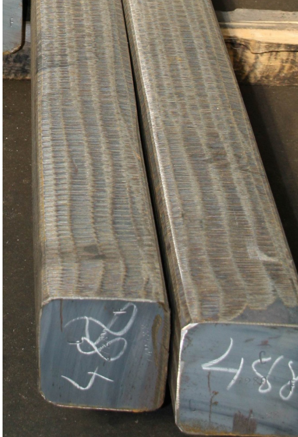
Abbildung 2: Knüppel nach Schleifen mit 120 mm Kantenlänge
