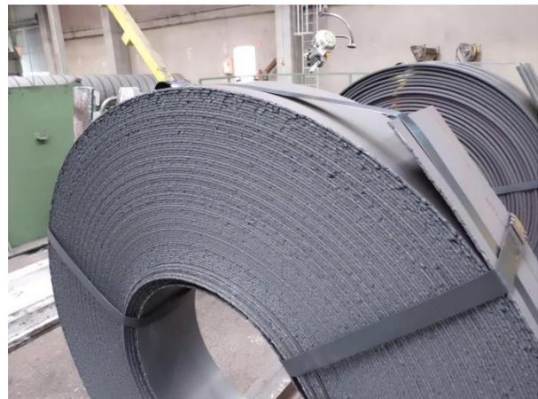
Abb. 11: leichte Kantenrisse am Warmband. Werkstoff Cronidur 30 (1.4108)
