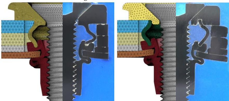
Abb. 7: Vergleich der Simulationsergebnisse mit einem Schlibbild des BMS-Systems
