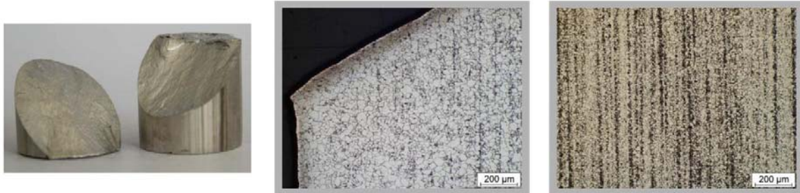
Abbildung 12: Legierung AZ80; v_f = 5 \text{ mm/s} ; T_f = 180^\circ\text{C} ; p_f = 800 \text{ bar} ; s_{\text{max}} = 6,5 \text{ mm} ; Schlibbilder aus dem Bereich der Bruchkante (Mitte) und aus dem Bauteilinneren (rechts) [9]
