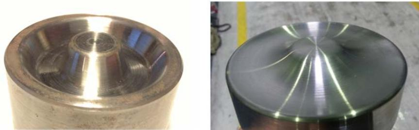
Abbildung 4: konturierte Gesenke zur Verschleißuntersuchung
