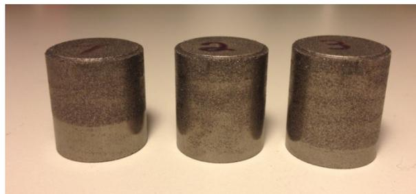
Abbildung 5: Gradierte Proben aus St- u. WC-Pulver (von links nach rechts: Proben mit 3, 4 und 5 Gradierungsschichten)
