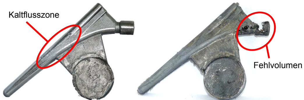
Abbildung 7: Bauteil mit Kaltfluss (links); Unvollständig ausgefülltes Bauteil (rechts)
