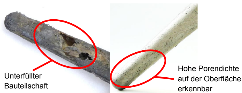
Abbildung 11: Unterfüllte Bauteile; Links: Unterfüllter Schaft (350°C); Rechts: Poren an der Bauteiloberfläche (450°C)
