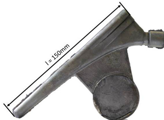
Abbildung 12: Vollständig ausgeformtes Versuchsbauteil aus der Legierung CoCr28Mo6
