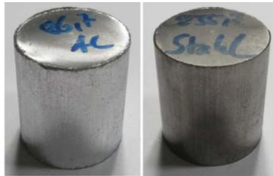
**Abbildung 5: Sinterrohteile aus Aluminium (links) und Stahl (rechts)**
