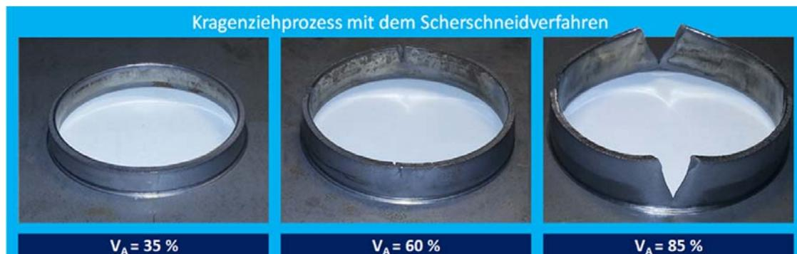
**Abbildung 5: Umformergebnisse nach unterschiedlichen Aufweitungen**
