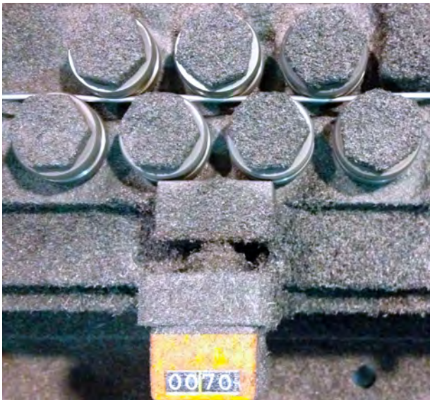
Abbildung 5: Elastisch-plastische Verformung des Drahtes im Diagnosegerät
