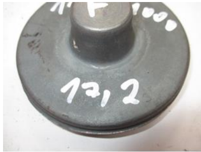
Mit Fase (Grat abgeschliffen)
