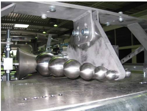
Abbildung 2: Abbildungen der Auffaltvorrichtung zur Herstellung von Magnesiumblechen.
