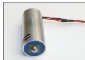
b) Aktor in Hülse eingegossen
