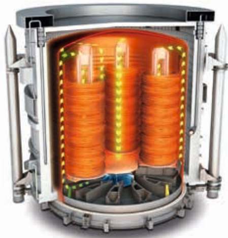
▲ Bild 6 Prinzipieller Aufbau eines HPH® Haubenglühofens
