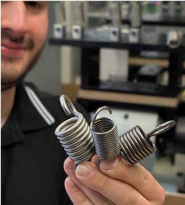
Abb. 1. Christian Otto zeigt Beispiele der betrachteten Zugfedern. V.l.n.r.: Ganze deutsche Öse seitlich, halbe deutsche Öse, englische Öse. © TU Ilmenau
