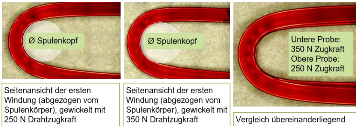
Abbildung 12: Einfluss der Drahtzugkraft auf die geometrische Ausprägung des Wickelkopfes
