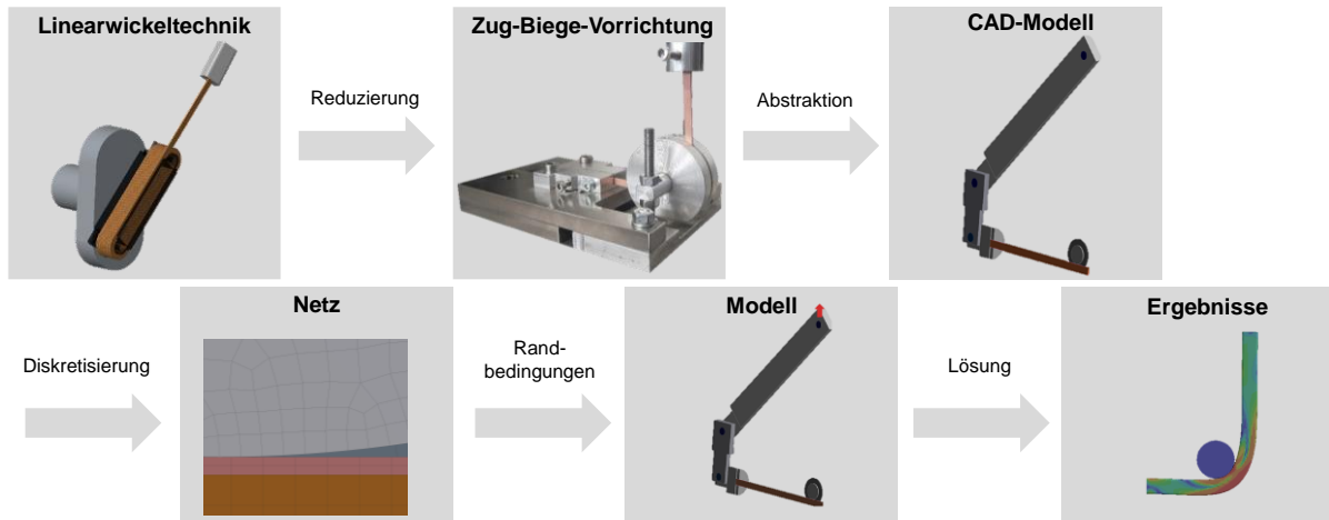
Abbildung 4: Vorgehen zur simulativen Abbildung des Spulenwickelprozesses
