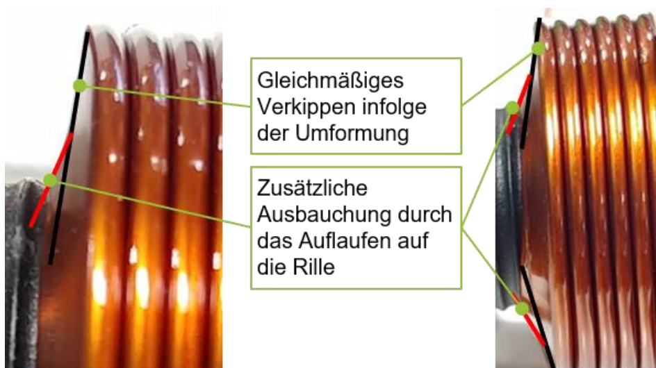
Abbildung 13: Verdeutlichung der Verkippung des Drahtes im Wickelkopf, durch die Analyse der Flanken des Drahtes
