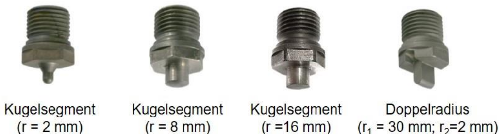
Abbildung 3: PIN-Gestaltung: Einschraub-PIN mit Hartmetalleinsatz (K10)
