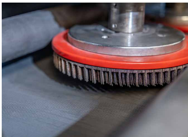
Der neue HERO R2 Entgratteller wurde von boeck für höchste Ansprüche an die Kantenbearbeitung entwickelt und von n-cut24 im Praxistest erprobt, um gemeinsam neue Maßstäbe für präzises Entgraten zu setzen. © boeck
