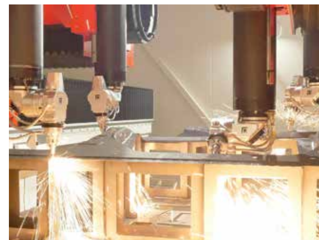
Beim „Giga Laser Next“ handelt es sich um ein 3D-Laserschneidsystem mit vier Köpfen. © Prima Power
